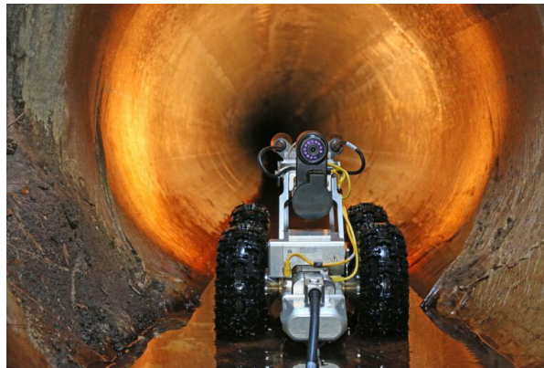
Slika 4. Motorizirana kolica s CCTV kamerom [30]
