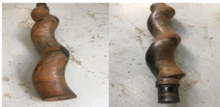
Slika 7. Kavitacijska erozija rotora crpke [5]
