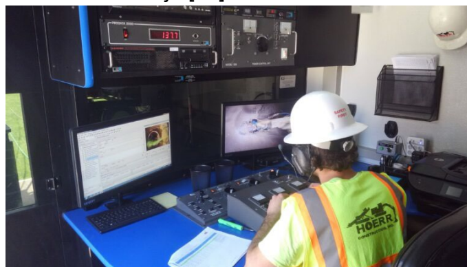
Slika 5. Operater za CCTV inspekciju te oprema [30]
