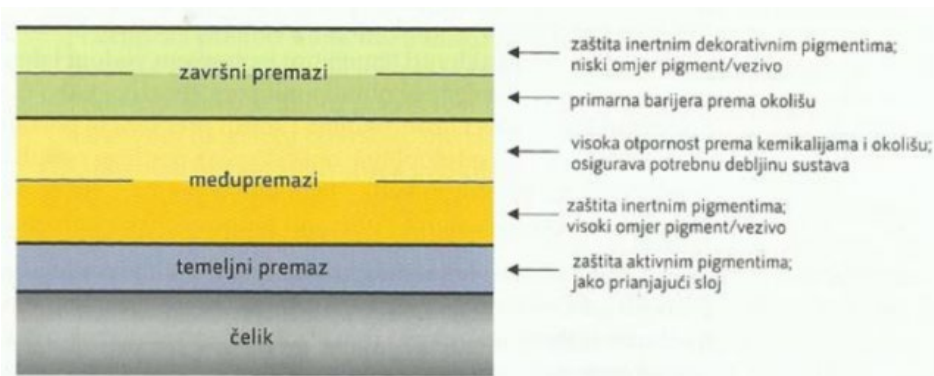
Slika 1. Slojevi u apliciranom sustavu organskog premaza [7]
