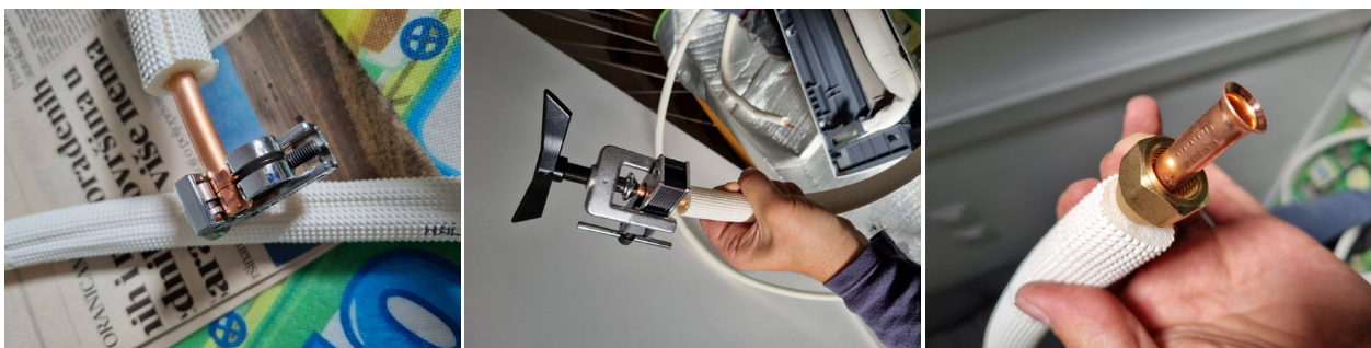
Slika 14. Obrada kraja cijevi, pertlanje i izgled ispravnog spojnog mjesta
