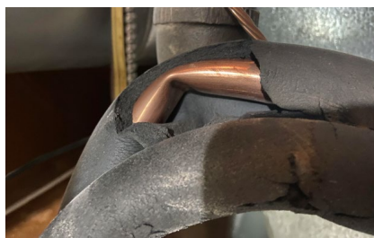
Slika 2. Nagnječenje bakrene cijevi, [16]
