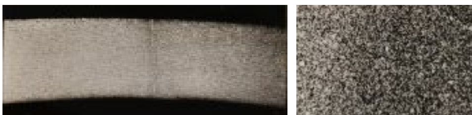
Slika 4. Makro i mikro struktura zavara, cijev grupe II nakon toplog valjanja cijevi
