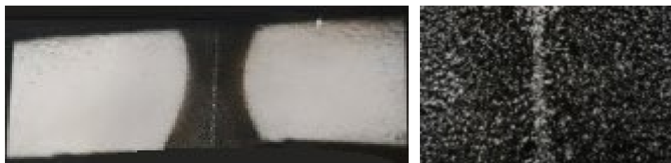
Slika 3. Makro i mikro struktura zavara, cijev grupe II nakon zavarivanja cijevi
