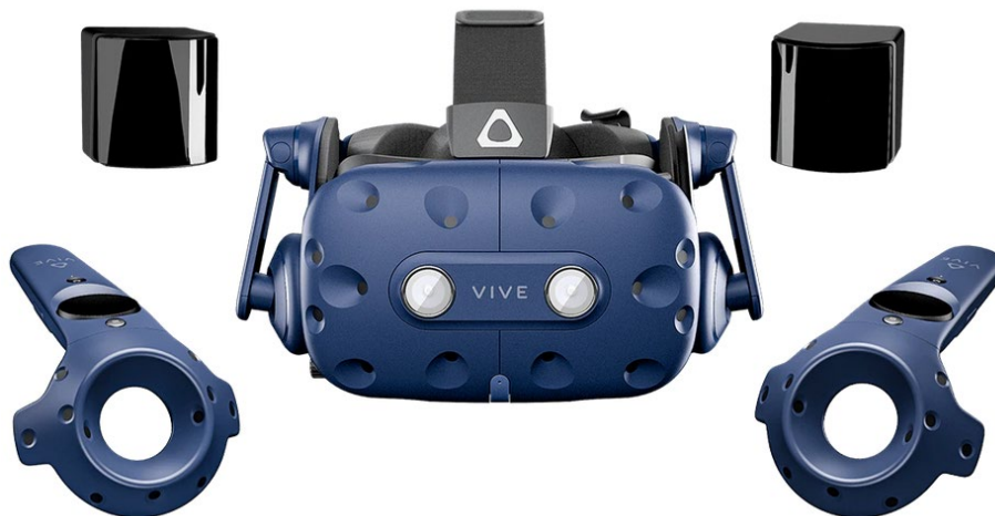
Slika 4. VR headset HTC Vive Pro – osnovni dijelovi [8]
