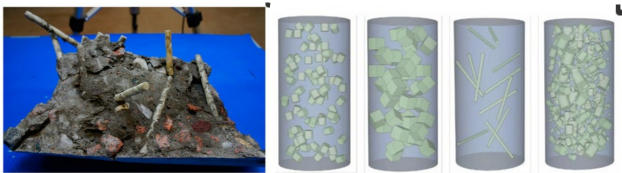
Slika 6. Primjeri ispune mehaničkim reciklatom u uzorcima betona, [8, 9]
