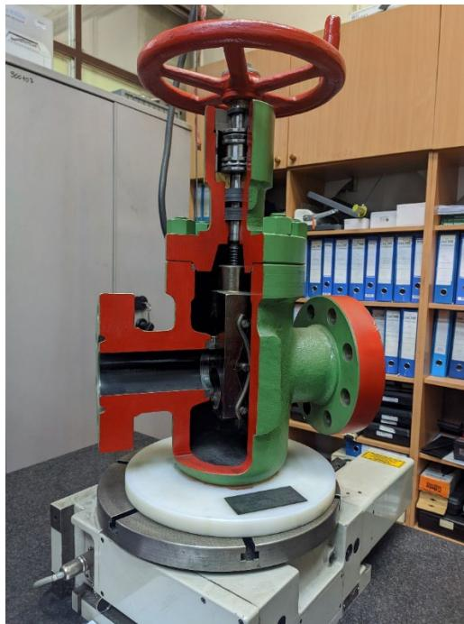
**Slika 1.** Poprečni presjek zasuna 2 9/16" [2]
