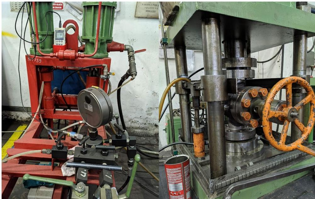
**Slika 3.** Mjerna stanica za hidrostatičko ispitivanje [2]
