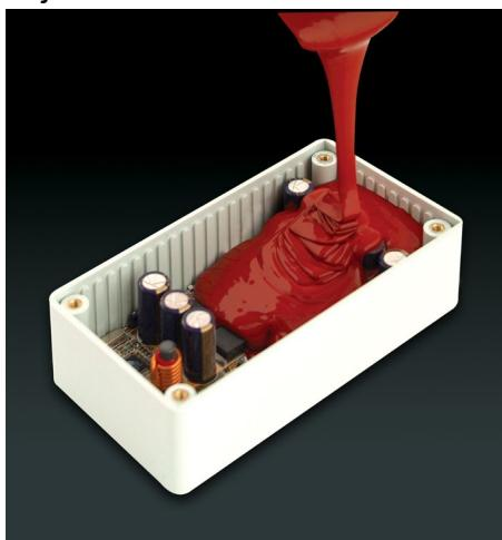
**Slika 1.** Proces zalijevanja elektronike zaštitnom masom [1]
