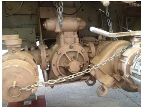
Slika 3. Primjena trokrilne zupčaste pumpe [2]
