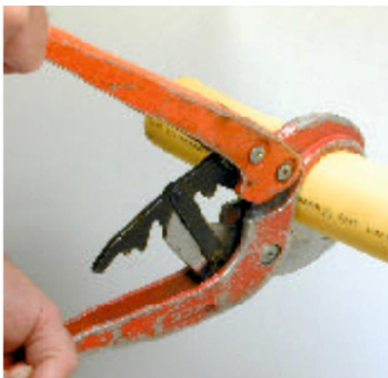
Slika 1. Odrezivanje cijevi pod kutom od 90° pomoću škara [4]
