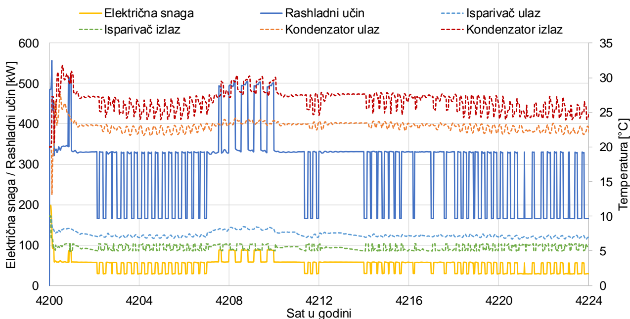
Slika 17. Primjer rezultata simulacije – rad kompresijskog rashladnog uređaja
