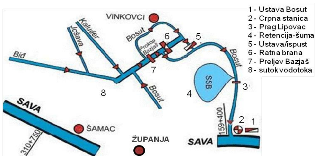
Slika 2. Shema hidrotehničkog sustava Pobosuća, [12]
