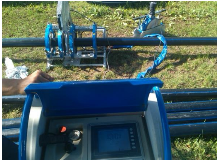
Slika 4. Princip zavarivanja postupkom grijaće ploče
