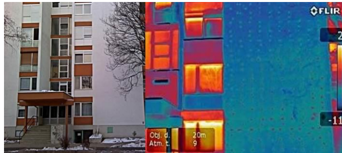
Slika 4. Primjer točkastih toplinskih gubitaka [30]
