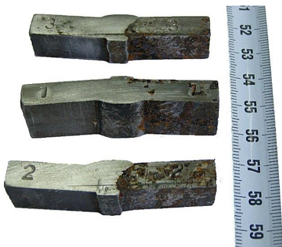
Slika 10. Uzorci 1, 2 i 3 zavarenih S235JR iX6CrNiMoTi 17-12-2 čelika nakon 120 sati, pogled A
