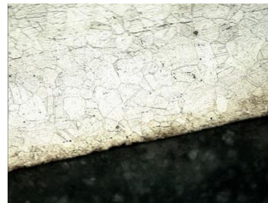
Slika 15. Mikrostruktura uzorka 2, čelika X6CrNiMoTi 17-12-2 nakon ispitivanja u vlažnoj komori Povećanje: 200:1, nagrizanje: Glycergia Struktura: austenitna sa prisutnošću karbida
