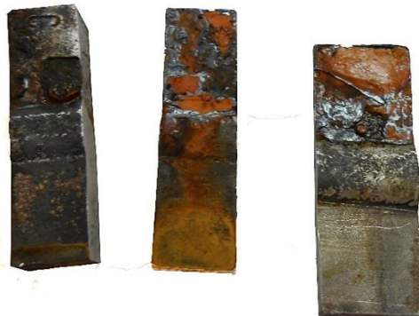
Slika 9. Uzorci 1, 2 i 3 zavarenih S235JR, X6CrNiMoTi 17-12-2 čelika nakon 48 sati, pogled B
