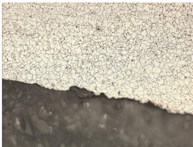
Slika 14. Mikrostruktura uzorka 2, čelika S235 JR nakon ispitivanja u vlažnoj komori Povećanje: 200:1, Nagrizanje: Glycergia Struktura: feritno- perlitna
