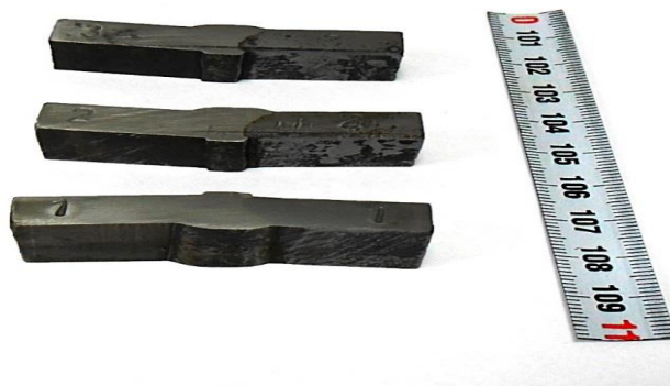
Slika 7. Uzorci 1, 2 i 3 zavarenih S235JR i X6CrNiMoTi 17-12-2 čelika prije stavljanja u vlažnu komoru
