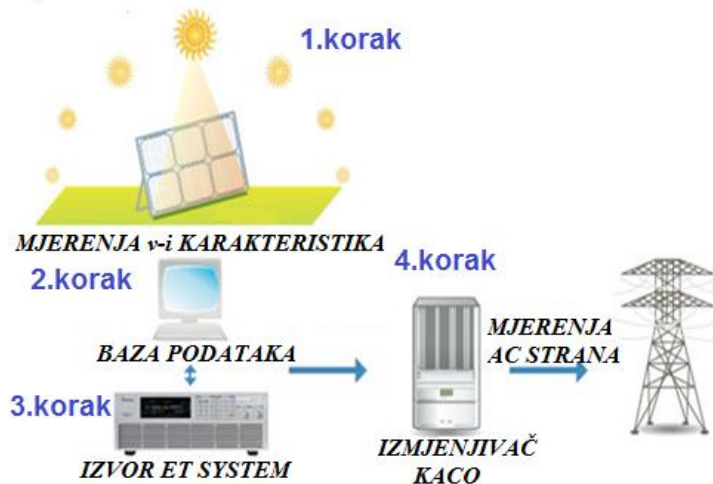
Slika 2. Koraci pri procjeni proizvodnje FN sustava
