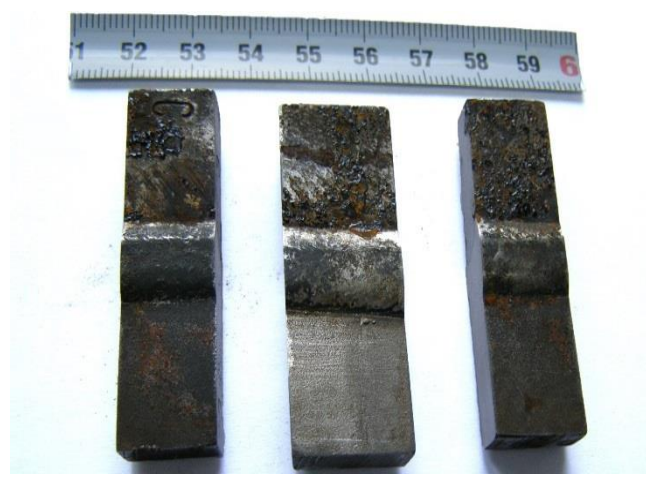
Slika 11. Uzorci 1, 2 i 3 zavarenih S235JR iX6CrNiMoTi 17-12-2 čelika nakon 120 sati, pogled B
