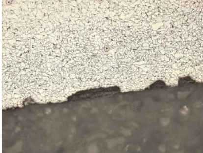
Slika 12. Mikrostruktura uzorka 1, čelika S235 JR nakon ispitivanja u vlažnoj komori Povećanje: 200:1, Nagrizanje: Glycergia Struktura: feritno- perlitna
