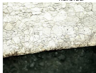
Slika 17. Mikrostruktura uzorka 3, čelika X6CrNiMoTi 17-12-2 nakon ispitivanja u vlažnoj komori, Povećanje: 200:1, nagrizanje: Glycergia Struktura: austenitna sa prisutnošću karbida
