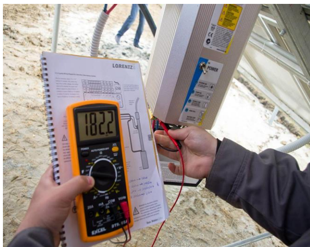
Slika 14. Testiranje upravljačkog sklopa
