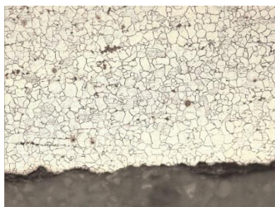
Slika 16. Mikrostruktura uzorka 3, čelika S235 JR nakon ispitivanja u vlažnoj komori Povećanje: 200:1, Nagrizanje: Glycergia Struktura: feritno- perlitna
