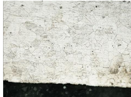
Slika 13. Mikrostruktura uzorka 1, čelika X6CrNiMoTi 17-12-2 nakon ispitivanja u vlažnoj komori Povećanje: 200:1, nagrizanje: Glycergia Struktura: austenitna sa prisutnošću karbida
