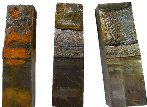
Slika 8. Uzorci 1, 2 i 3 zavarenih S235JR i X6CrNiMoTi 17-12-2 čelika nakon 48 sati, pogled A
