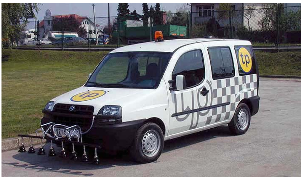
Slika 4. Vozilo za kontrolu plinske mreže
