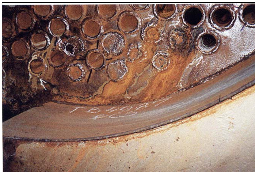
Slika 2.4 Izgled prednje cijevne stijene na desnoj strani kotla [1]
