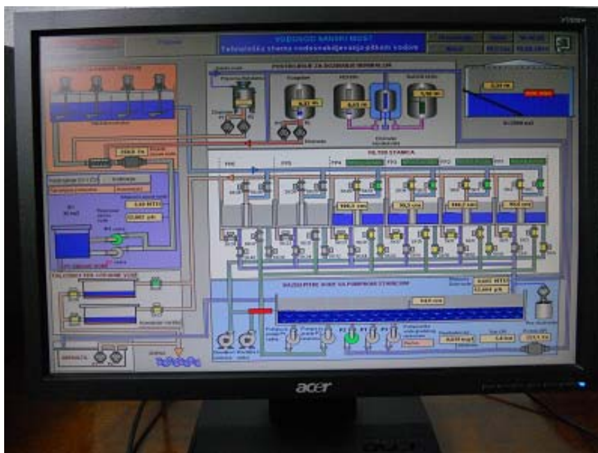
Slika 1. JKP «ViK» Sanski Most, schema Centralne nadzorne jedinice
