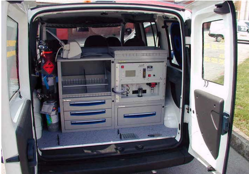
Slika 5. Uređaj za detekciju plina
