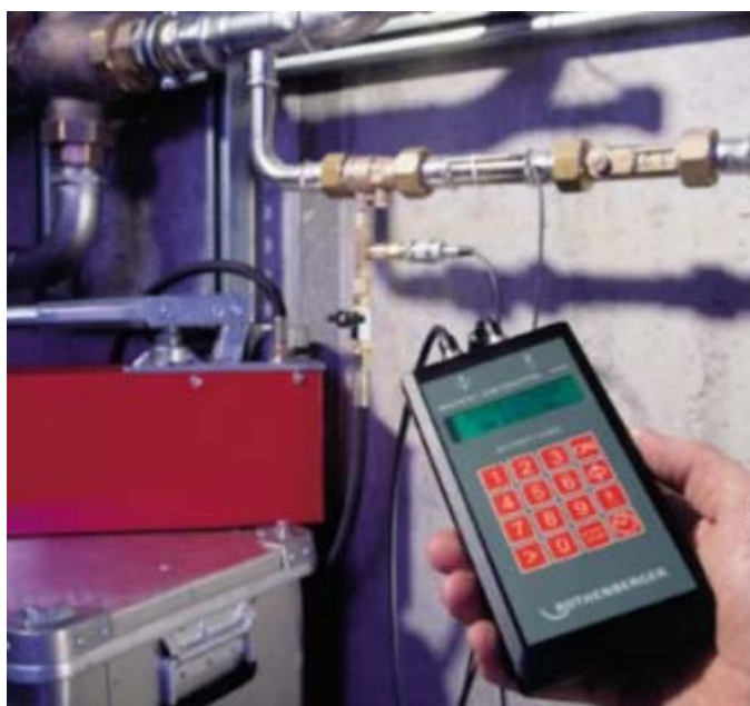
Slika 4. Digitalno očitavanje rezultata tlačne probe, [21]
