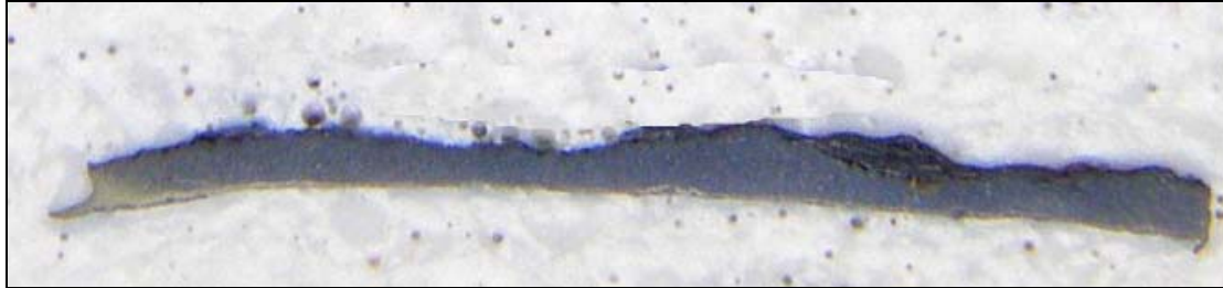
Slika 14 Ispitni uzorak zaliven u polimernu masu [7]
