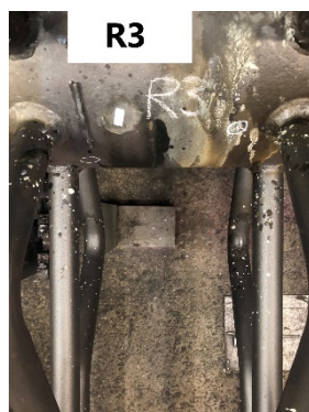
Slika 8. Metalografska replika postavljena na ispitno mjesto R3
