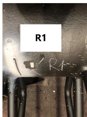
Slika 2. Metalografska replika postavljena na ispitno mjesto R1
