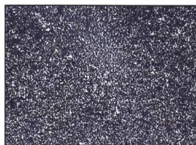
Slika 18. Struktura ZUT (sa strane materijala 1.1106) - MAG [8]
