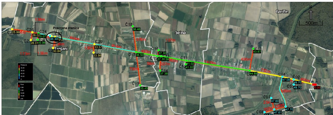
Slika 3.: Hidraulička shema u trenutku maksimalne satne potrošnje
