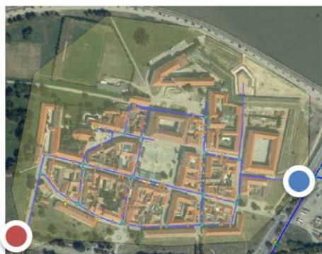
Slika 2. Primjer formiranja privremene DMA zone sa 1 mjernim mjestom i 1 zatvorenim graničnim ventilom
