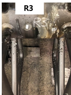
Slika 8. Metalografska replika postavljena na ispitno mjesto R3
