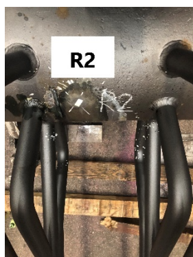
Slika 5. Metalografska replika postavljena na ispitno mjesto R2
