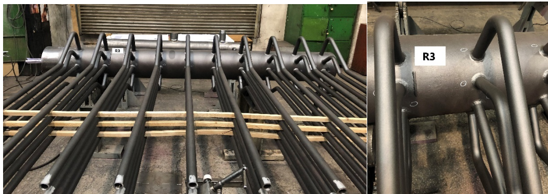
Slika 7. Dio komore s označenim mjestom uzimanja metalografske replike za ispitno mjesto R3
