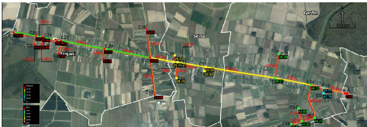
Slika 4.: Hidraulička shema za slučaj protupožarne količine vode u kritičnoj točki Č28, Q= 10 \text{ l/s}
