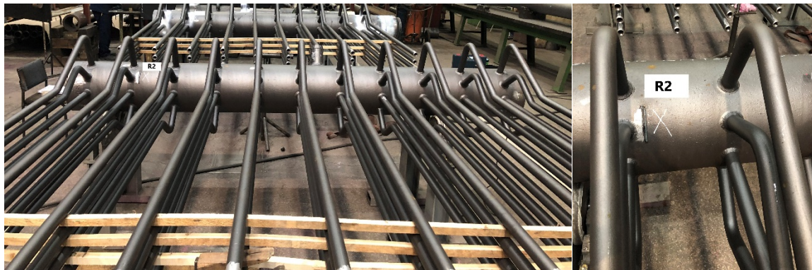
Slika 4. Dio komore s označenim mjestom uzimanja metalografske replike za ispitno mjesto R2
