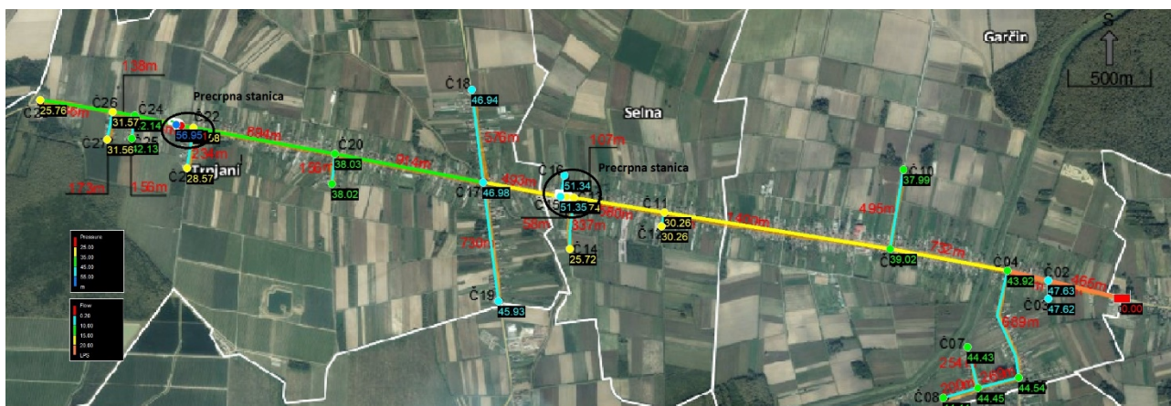
Slika 5.: Hidraulička shema za slučaj protupožarne količine vode u kritičnoj točki Č28, Q= 10 \text{ l/s} s pripadajućim mjerama za osiguranje potrebnih tlakova
